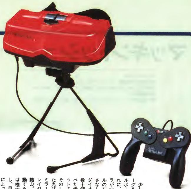
少し大きめのゴーグルが本体。それに、コントロールがつかう。ゴーグルの左右には、小さなLED、発光ダイオード、二百数十個をタテに並べた光源が2組セットされている。そのLEDから出た光は、レンズ、ミラーを通してプレイヤーの目に像を結ぶ。ミラーが振動することで、光は横方向に走査し、目の残像効果によって2次元の映像が得られる。さらに右目と左目に微妙にタイミングのずれた映像を送り込むことで、立体間のあるステレオグラム映像が
